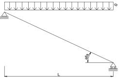
Carico distribuito sul cosciale  $qt=(a_{DD} \times 1,5 + a_{DD} \times 1,4) \times 1/2 = 2,20 \text{ N/mm}$ Lunghezza equivalente della rampa L' = 3430 mm
